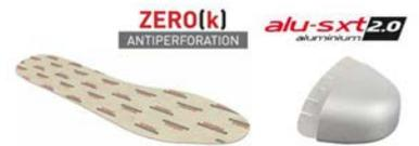
Nuovo puntale con gommino, in alluminio a spessori variabili funzionali. Resistente all'urto oltre 200joule. Lamina antiperforazione tessuta.resistente a più di 1100 N a perforazione zero
